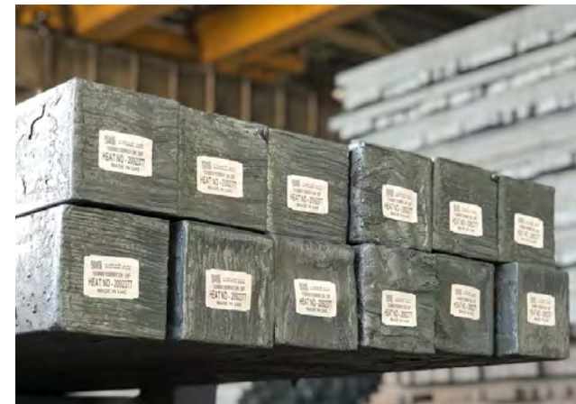
يتم تحويل مربعات الصلب إلى حديد تسليح أو لفائف أسلاك حديد في وحدات الدرفلة في المجموعة
